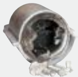
CATALISADOR DERRETIDO Sobreaquecimento
