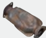
CAT. DANIFICADO POR IMPACTO Impacto sob o veículo que danificou o catalisador
