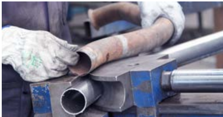
Máquinas de dobragem de tubos/ mandril
