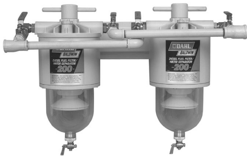
MODELO 200-MFV Filtro Doble de Combustible Diesel/Separador de Agua, con Múltiple y Válvulas de Corte para Operación Continua
