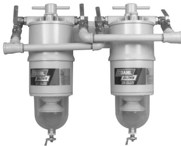
MODELO 300-MFV Filtro Doble de Combustible Diesel/Separador de Agua, con Múltiple y Válvulas de Corte para Operación Continua
